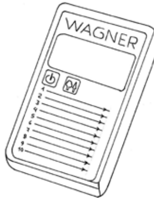
Dibujo N° 14 . Higrómetro de contacto
