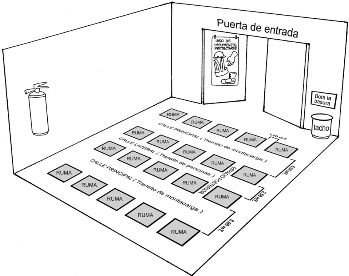
Dibujo N° 30 . Elementos de seguridad en el patio de secado
