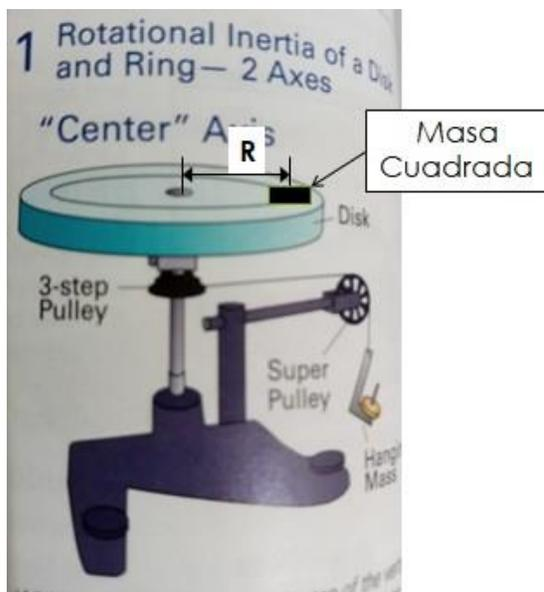
**Figura 8.3** El radio **R** y la masa cuadrada en la plataforma giratoria, datos para determinar la Inercia Rotacional Teórica
