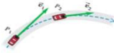
Figura 4. El automóvil frena al tomar la curva, cambiando así, tanto la dirección como la magnitud del vector velocidad.
