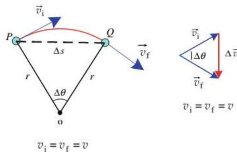
Figura 10. Representación del cambio de dirección de la velocidad de una partícula con movimiento circular uniforme
