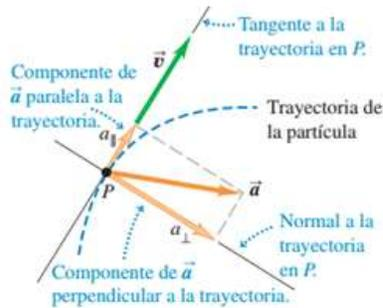
Figura 6. Descomposición del vector aceleración de una partícula en sus componentes, paralela a la trayectoria (es decir, tangente a la trayectoria), y perpendicular a la trayectoria (es decir, en la normal a la trayectoria).
