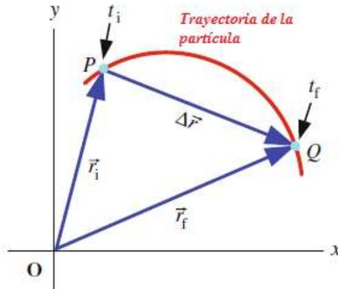
Figura 2. Representación del vector desplazamiento de una partícula en un sistema bidimensional
