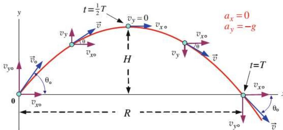
Figura 8. Trayectoria de un proyectil lanzado con una velocidad  $\vec{v}_0$  y ángulo  $\theta$  con el eje x
