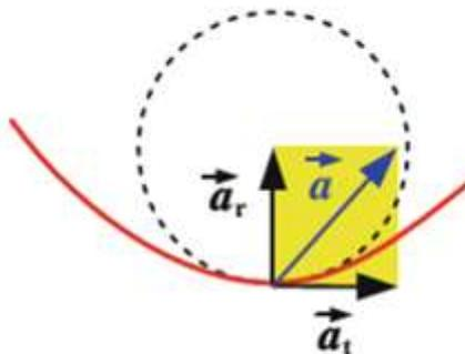
Figura 11. Representación gráfica de la componente radial y tangencial de la aceleración de una partícula en un movimiento circular no uniforme
