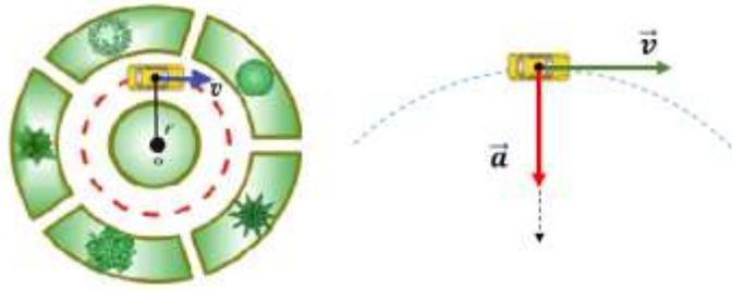
Figura 9. Automóvil con movimiento circular uniforme, la rapidez es constante y la aceleración se dirige hacia el centro de la trayectoria circular
