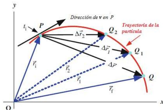
Figura 3. Representación de la dirección del vector Velocidad a medida que  $\Delta t$  tiende a cero. La velocidad media tiene la misma dirección que  $\Delta\vec{r}$ , pero la velocidad instantánea es tangente a la trayectoria.
