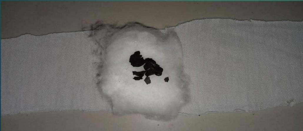
5. Coloque sobre el algodón, el trozo de carbón activado suministrado. Luego coloque otra capa de algodón sobre el carbón, de tal forma que quede cubierto.
