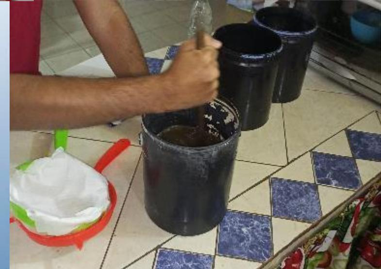
**Colador Verde Pcl1:** Antes empezar la mezcla y verter el agua simulada a otro balde, se toma registro sobre el peso de los coladores sin residuos. Se vierte la mezcla en el balde utilizado Pcl1 para observa la cantidad de solidos retenido en su transmisión, y luego se procede a tomar su peso con la cantidad de solidos conseguidos, observamos muchos restos de suciedad en el fondo del balde.
